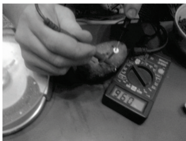
Рис. 1. Гальванический элемент, изготовленный с использованием картофеля
