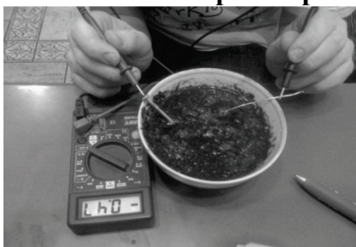
Рис. 3. Гальванический элемент, изготовленный с использованием почвы, пропитанной соляным раствором
